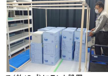
資料整理室内のオープンスペース(約15㎡)にテント設置 (イレクターパイプ骨組+ガスバリアシート、容積約7㎡)
