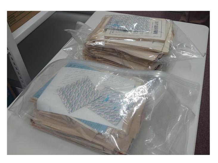
3連ファスナーの専用ガスバリア袋に 脱酸素剤・酸素検知剤と資料を封入
